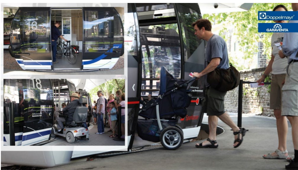
Bild 6: Barrierefreier Zugang der Seilbahn in Koblenz (Bild: Doppelmayr/Garaventa)
